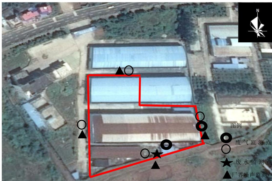
图 3.1-1 项目平面布置及主要污染源监测布点图
