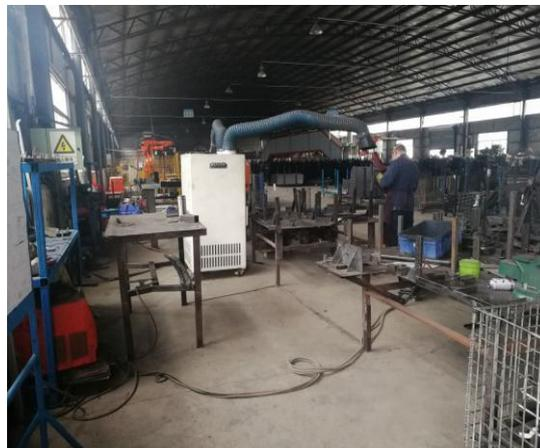
移动式焊接烟尘净化器
